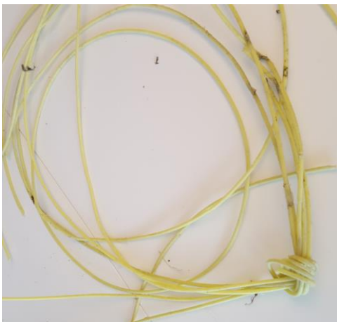
Figur 1. Bildene er tatt av skyteledning (venstre) og to typer armeringsfibre (høyre) funnet i området i Moss Havn hvor det er brukt sprengsteinmasse for tildekking av forurenset sjøbunn.
