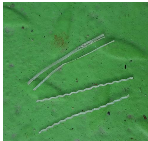
Figur 1. Bildene er tatt av skyteledning (venstre) og to typer armeringsfibre (høyre) funnet i området i Moss Havn hvor det er brukt sprengsteinmasse for tildekking av forurenset sjøbunn.
