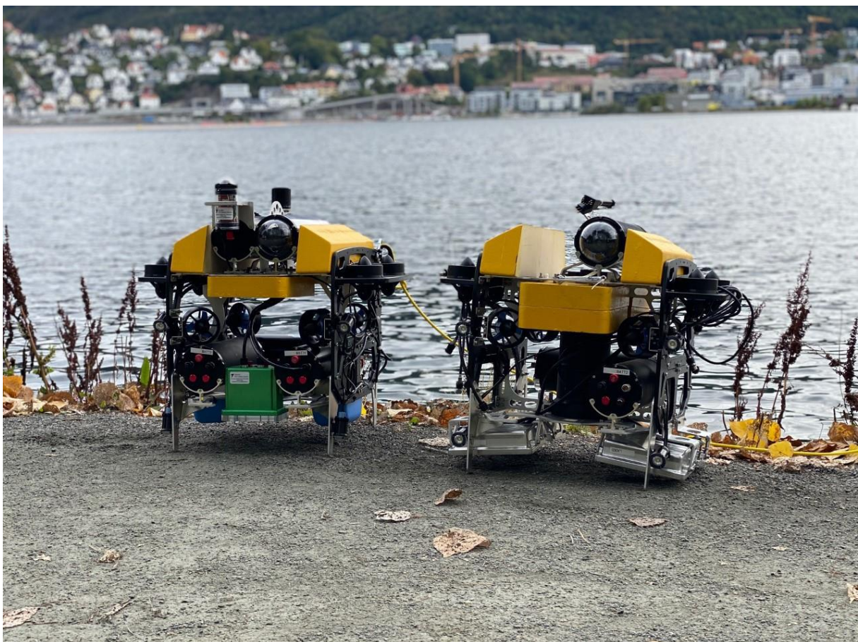
Figur 2. Undervannsfarkostene som ble brukt under undersøkelsen. Farkost SROV (stereokamera [til venstre]) og farkost UROV (undervannsspektralkamera).
